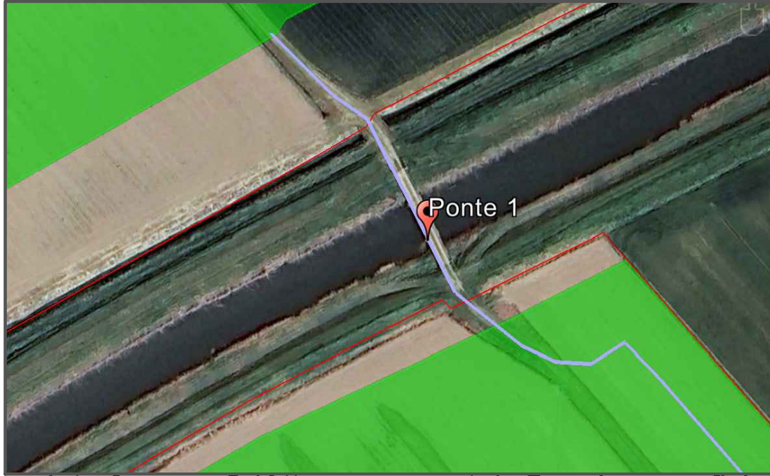
Interferenza 2 (Attraversamento): Canale superficie Risoluzione: Staffaggio su ponte
