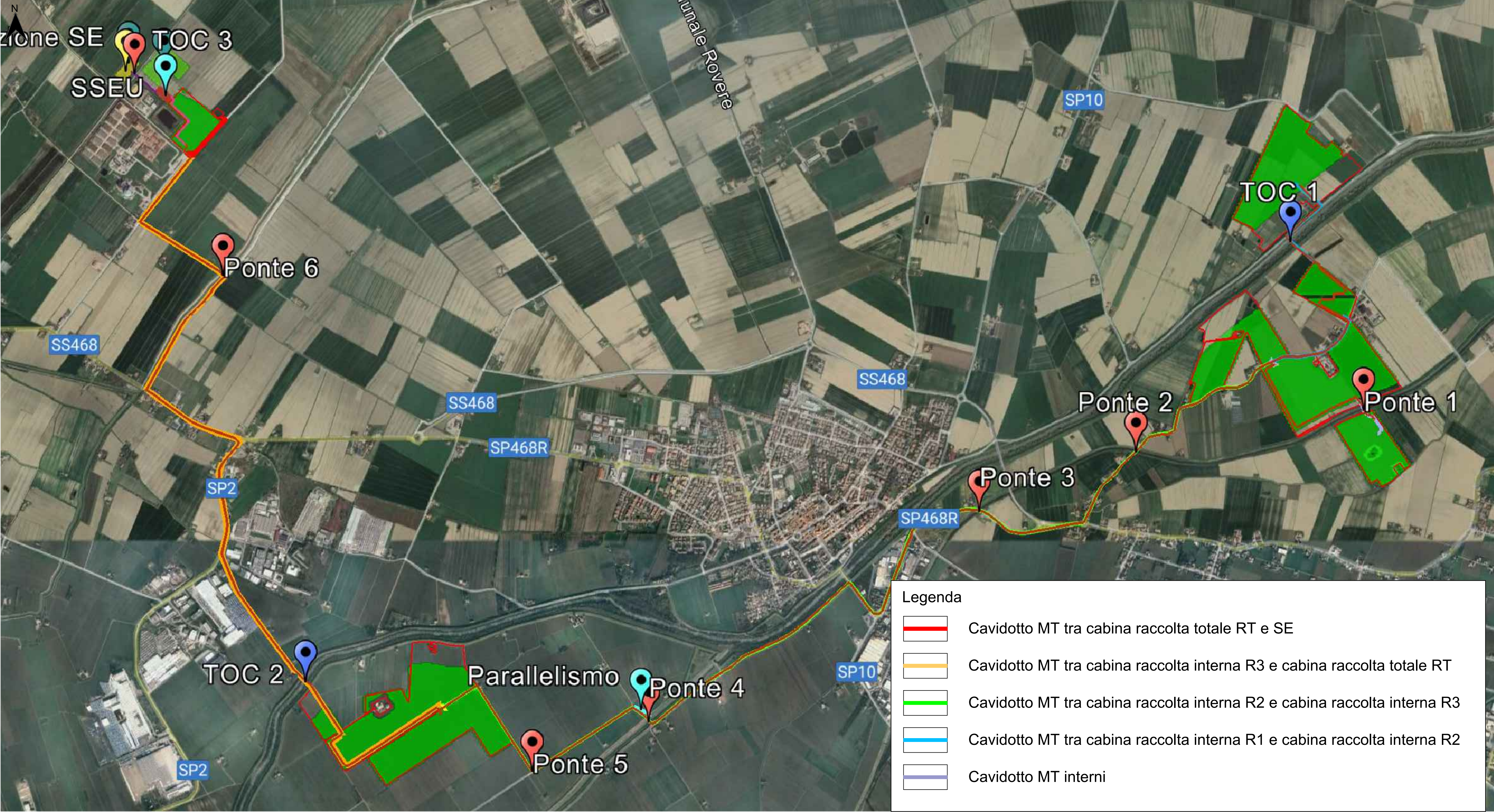
Rappresentazione interferenze tra cavidotti MT d'impianto. Scala 1:15.000
